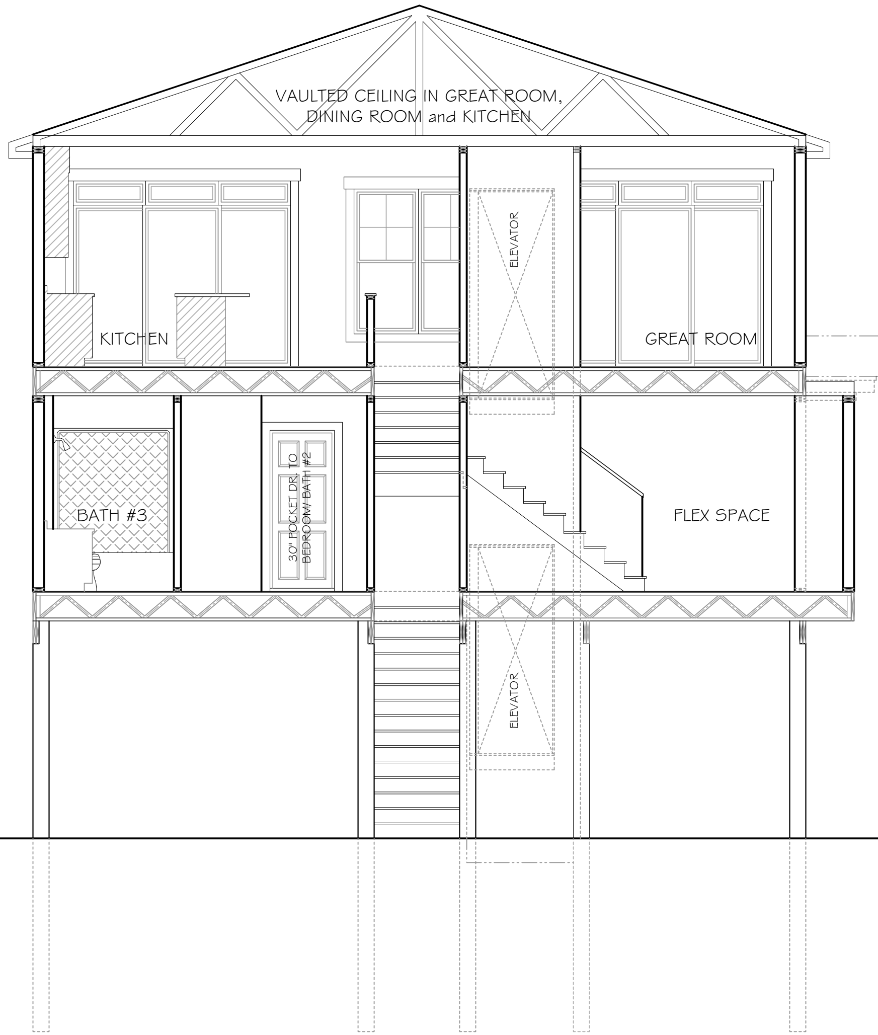
A2 SECTION SCALE: 1/4" = 1'-0"
